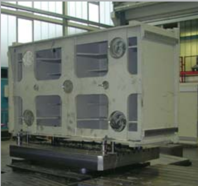
CNC gesteuerter und hydrostatisch geführter Dreh-Verschiebetisch
