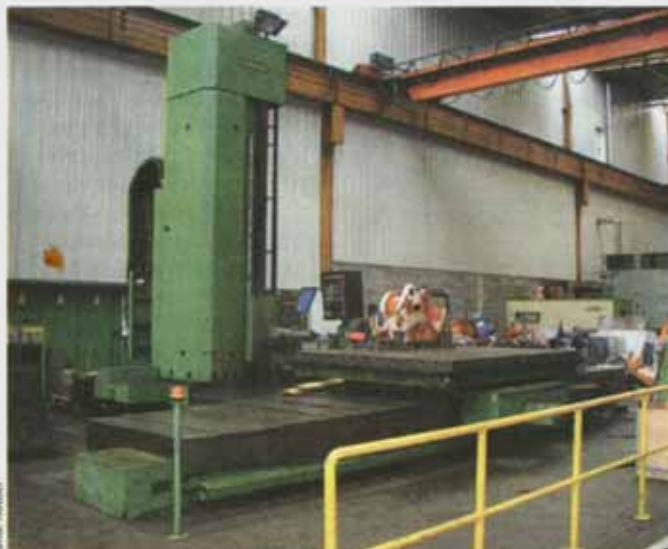
Das Tischbohrwerk mit 60 kW Spindeltriebsleistung wurde auf hydrostatische Führungen in Verbindung mit spielfreien Antrieben umgerüstet.
