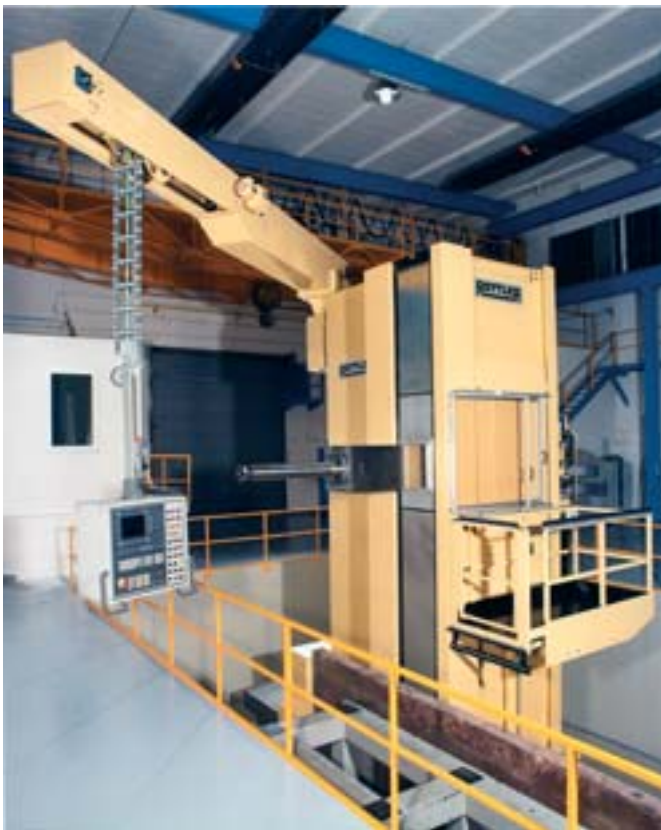
Maschine mit ausgefahrenem RAM und Spindel
