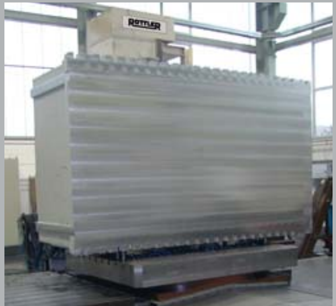
CNC gesteuerter und hydrostatisch geführter Dreh-Verschiebetisch
