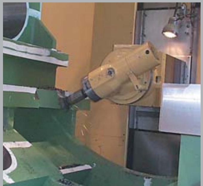
Großteilebearbeitung mit Orthogonal-Winkelfräskopf
