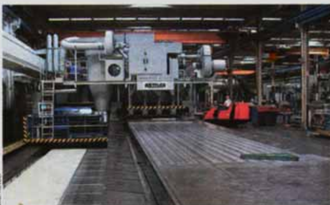
Gantry-Portalfräsmaschine für die Hochgeschwindigkeits-Aluminiumbearbeitung ist modular aufgebaut und deshalb leicht zu warten.
